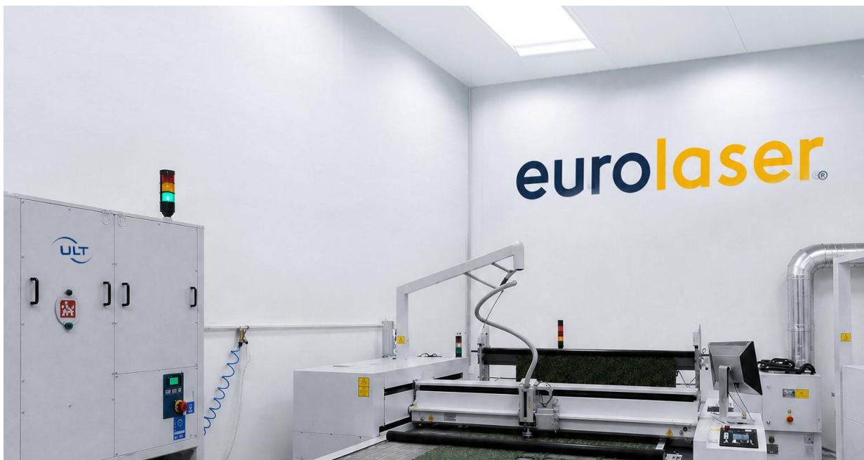
ULT LAS 800 (links) im Verbund mit der eurolaser-Laseranlage
